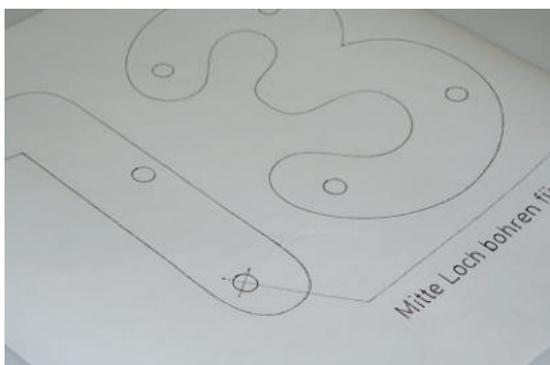
Sie bohren mittels der beigelegten Bohrschablone die Löcher und schrauben die Distanzhülse an die Wand.
